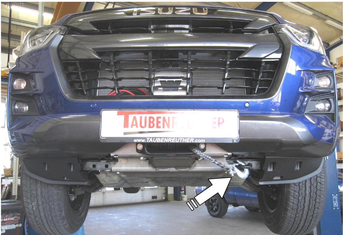
**31** **Seilhaken montieren und in die Abschleppöse einhängen!**
